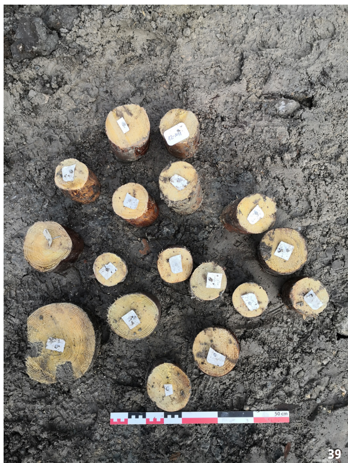
Fig. 39. St 2 (US 10, US 11, US 12). Echantillon sur pieux en vue des analyses dendrochronologiques.
