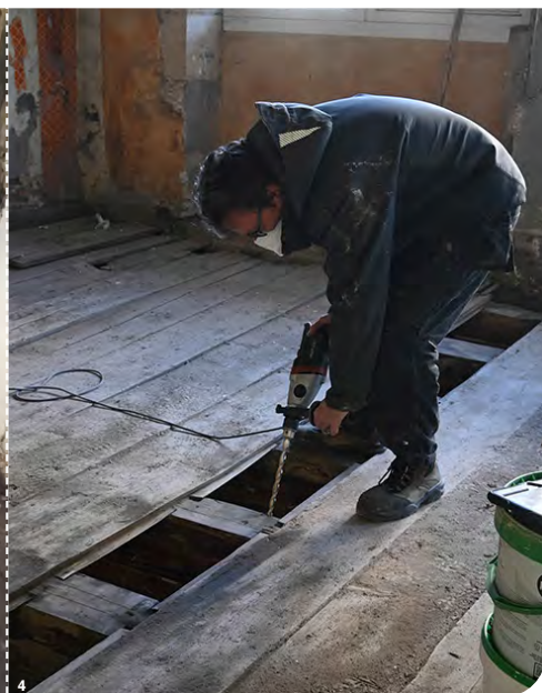
Fig. 2 : Relevé numérique de l'élévation (Archeodunum) et plan du rez-de-chaussée (©BY Architectes) - Fig.3 : Réalisation d'un sondage dans l'enduit et enregistrement des données sur tablette - Fig. 4 : Grâce à des prélèvements dans les bois, le laboratoire C.E.D.R.E peut procéder à des analyses dendrochronologiques.
